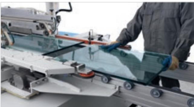
Les modules d'alignement à l'entrée facilitent la mise en place de la plaque dans la machine, grâce à une longueur adéquate de la zone d'entrée.
