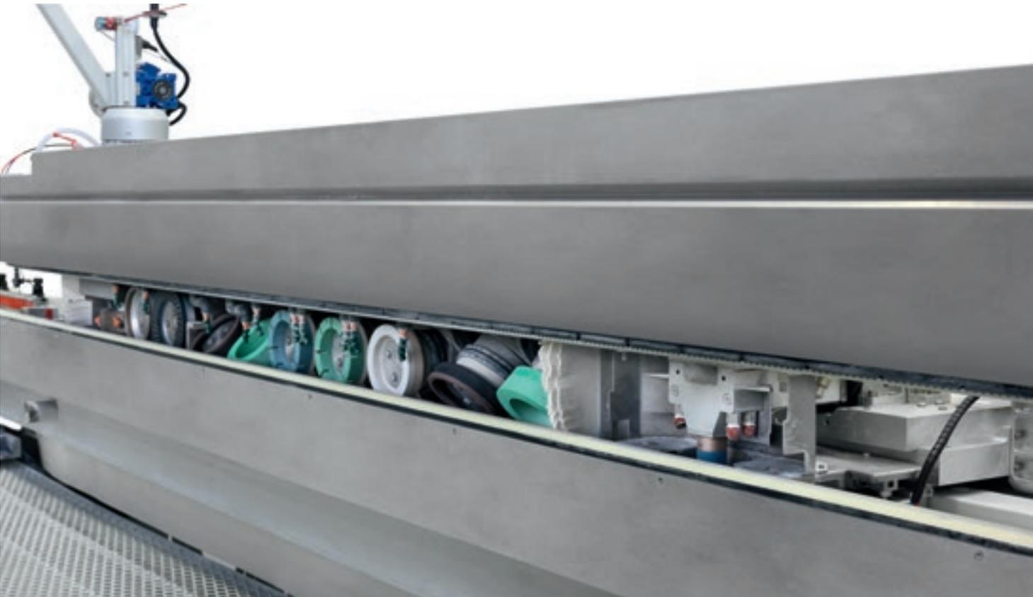
Le nouveau système pour les coins mouchés est totalement intégré dans la structure de la traverse.
