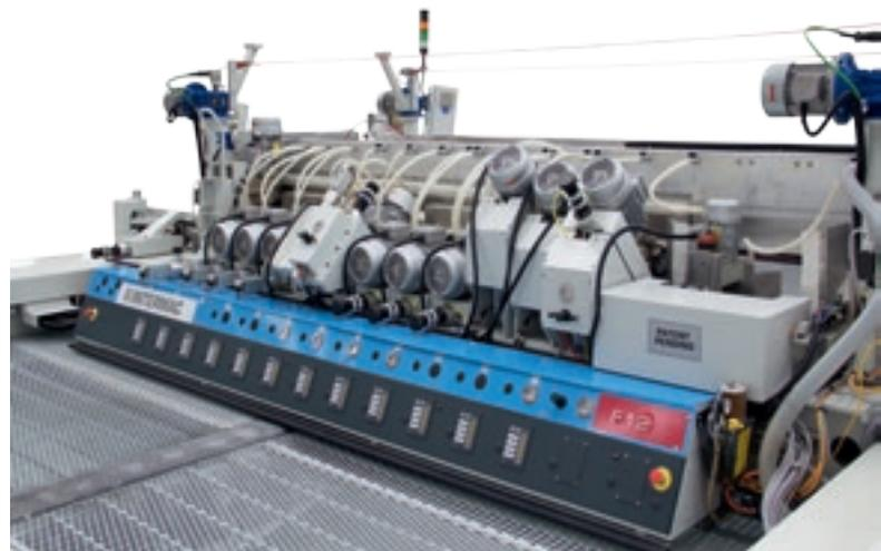
La structure solide des traverses permet de tenir l'eau éloignée des chariots d'actionnement des broches.
